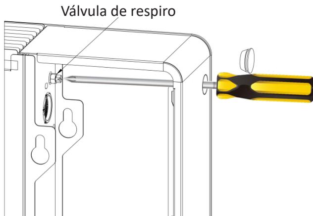
Se não existir energia eléctrica e a válvula termostática já estiver ligada eléctricamente, utilize a tampa especial para pressionar o limitador da válvula e abri-la.
